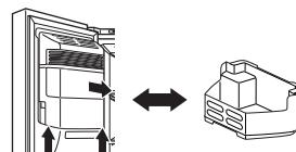
**4** Zásobník na led vložte zpět obráceným postupem, než při jeho vyjmutí.
