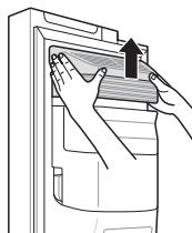
**3** Zásobník na led uchopte oběma rukama a zvedáním nahoru ho vyjměte. Přídavný
